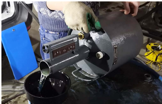
Ручная тарировка топливного бака с помощью мерной емкости занимает несколько часов
