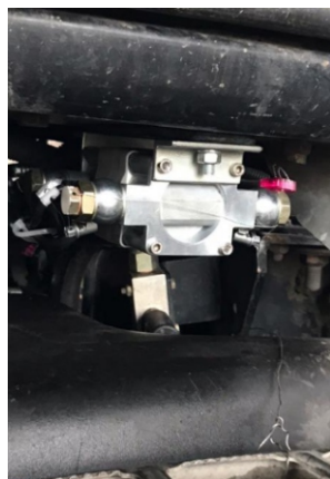
Расходомер DFM 500 D, установленный на тракторе
