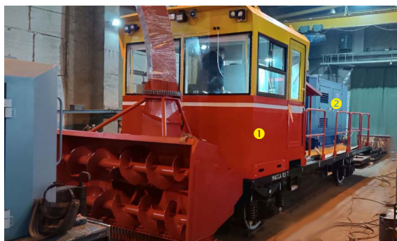
Снегоочиститель шнекороторного типа в заводском цеху ① кабина оператора, ② дизельный генератор
